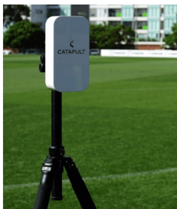
Εικόνα 11 - Κεραία συστήματος καταπέλτη
